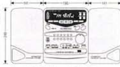
Peso totale del sistema (netto): 8,7kg Profondità massima: 289mm
